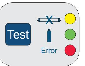
La module SelfControl est une unité de surveillance de quartz contrôlé pour les luminaires autonomes, qui exécute automatiquement des tests fonctionnels hebdomadaire et des tests annuels de durée.
