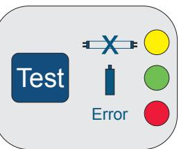
Das SelfControl Modul ist ein quarzgesteuerter Überwachungsbaustein für Einzelbatterieleuchten, welcher automatisch wöchentliche Funktionsprüfungen und jährliche Dauerprüfungen durchführt. Darüber hinaus besteht die Möglichkeit, diese Prüfungen auch manuell zu starten. Die Dauerprüfung kann für eine Bemessungsdauer von 1h, 3h und 8h eingestellt werden und deren automatische Auflösung kann deaktiviert werden.
